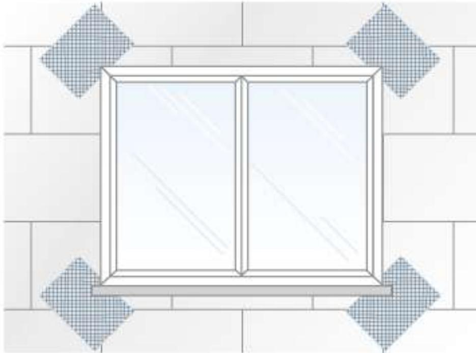
L'applicazione di questi fazzoletti di rete (cm 20x40 posizionati a 45°) sugli spigoli è una necessità per evitare tensioni e microlesioni superficiali del rivestimento a cappotto in queste zone
